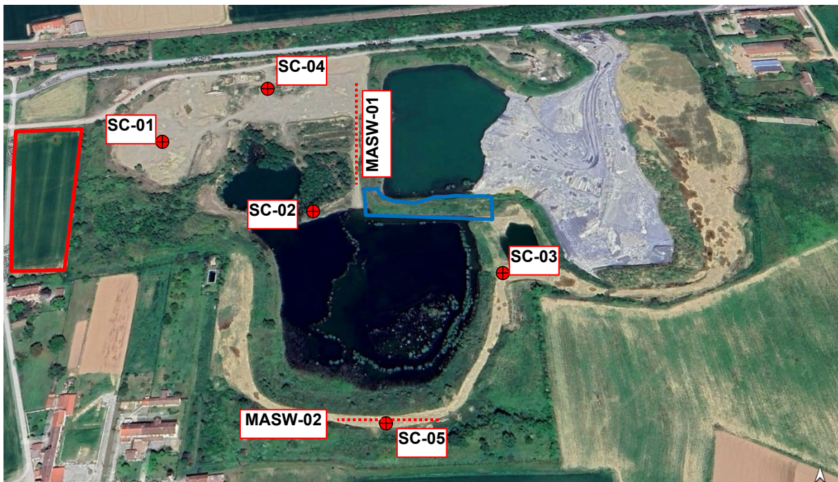
Figura 9 - Ubicazione su ripresa aerea delle indagini eseguite nella Campagna 2025 nell'area di Cava La Bolla 2. Il poligono in colore rosso individua il mappale 306 del Foglio catastale n. 212 in cui ricade la posizione del Pozzo 1, mentre nell'ambito del poligono in colore blu, corrispondente a parte del mappale 284, sempre del Foglio n. 212, è previsto il Pozzo 2. Legenda: SC-01 ÷ SC05 sondaggi verticali a carotaggio continuo; MASW-01 ÷ MASW-02 rilievi sismici MASW.
